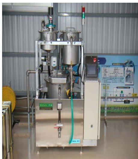
図 7. 2. 2-1 B D F 製造装置
