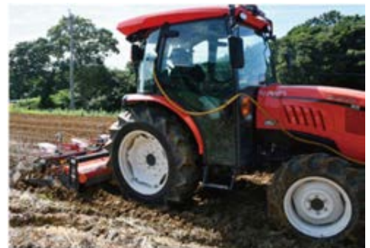
▲直進中、手放して作業できるため、振り返って後方の作業機の状態を確認できる。
