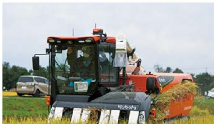
▲自動運転により刈取作業を行うアグリロボコンバインDR6130A
