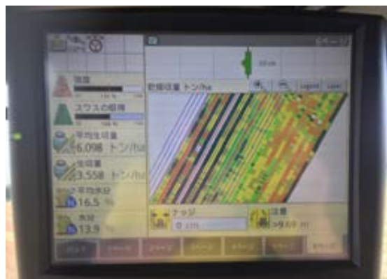
<モニターにリアルタイムで表示される収量マップ>
