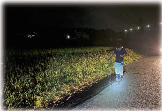
写真 3-7 職員による夜間時漏水調査
